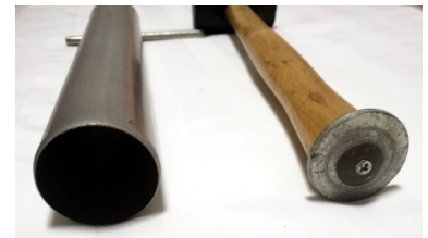
Figure 1: いろいろな道具を試してみましたが、一番気に入っているのは直径 4 cm ほどのステンレスのパイプです。先端部を少し鋭くしておきます。よく締まったきれいなコアを抜くことができ、深さ別に切り分けるのが簡単です。先細になっているサンプラーでは、土が崩れてしまいがちです。実際に OM246 用のサンプル採取に使ってみました。まっすぐなパイプの方が良いと感じました。
