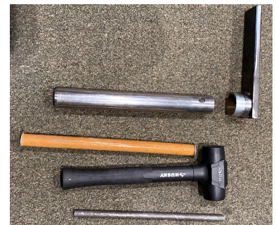
Figure 2: ヘーゼルティン GC で使われているサンプルングキット。直径 3 cm のパイプと打ち込み用の槌のキット。写真提供: Chris Tritabaugh.
